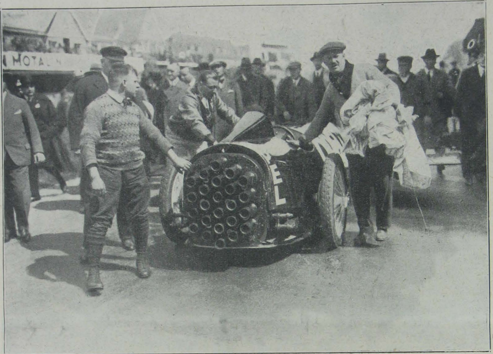
Fritz von Opel rakétaautójával a berlini Avus pályán starthoz áll. A rakétaautó hátsó részében látjuk a kipuffogókat, ahova a rakéták kerülnek.
