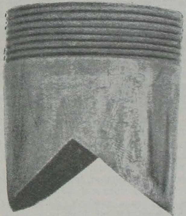
Az antipyrophor nevű kutató cső felcsavarható vége. Ezzel az antipyrophorral lehet megállapítani az öngyulladásos tüzfészket és csatornákat a szénarakásban.
