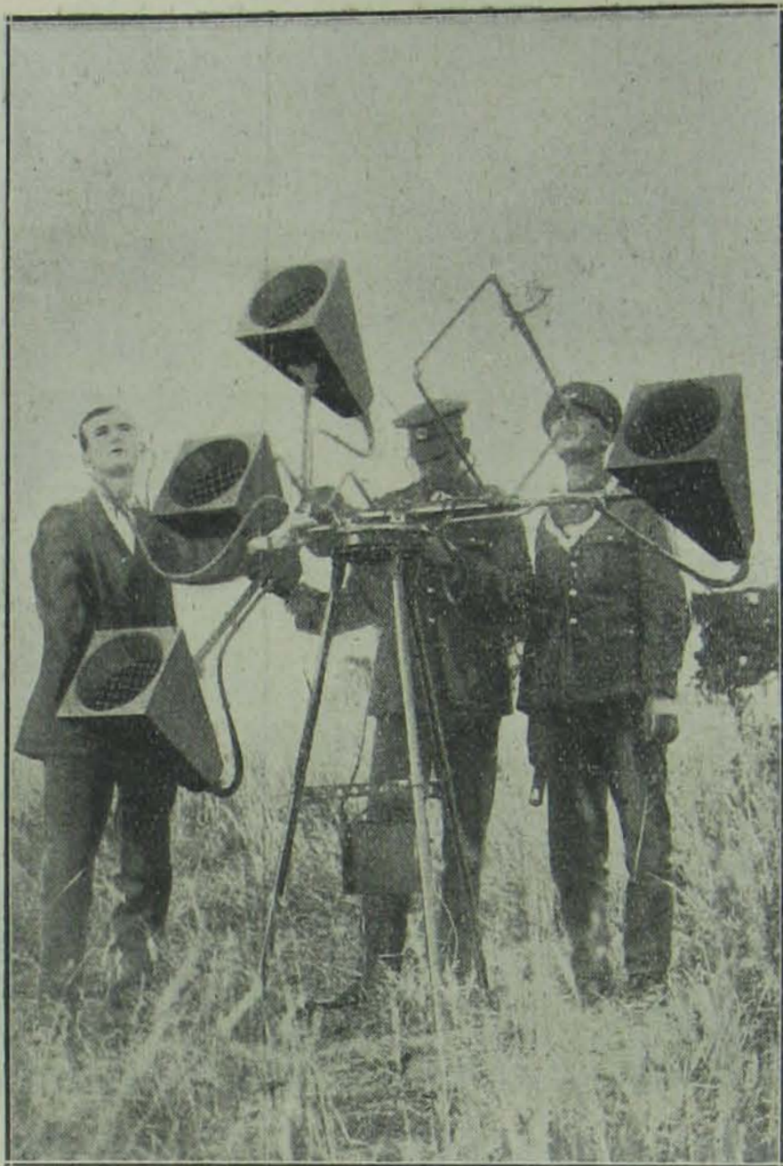
Az angol légi gyakorlatoknál ilyen halló-készüléket próbáltak ki, mely közeledő repülőgépek zaját nagy távolságból is elárulja.
