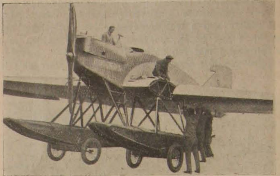
7. ábra: Egysíkú vastagszárnyú vízi-szárzsföldi fémgép (amphibia) kétszárnyú húzó légcsavarral.
