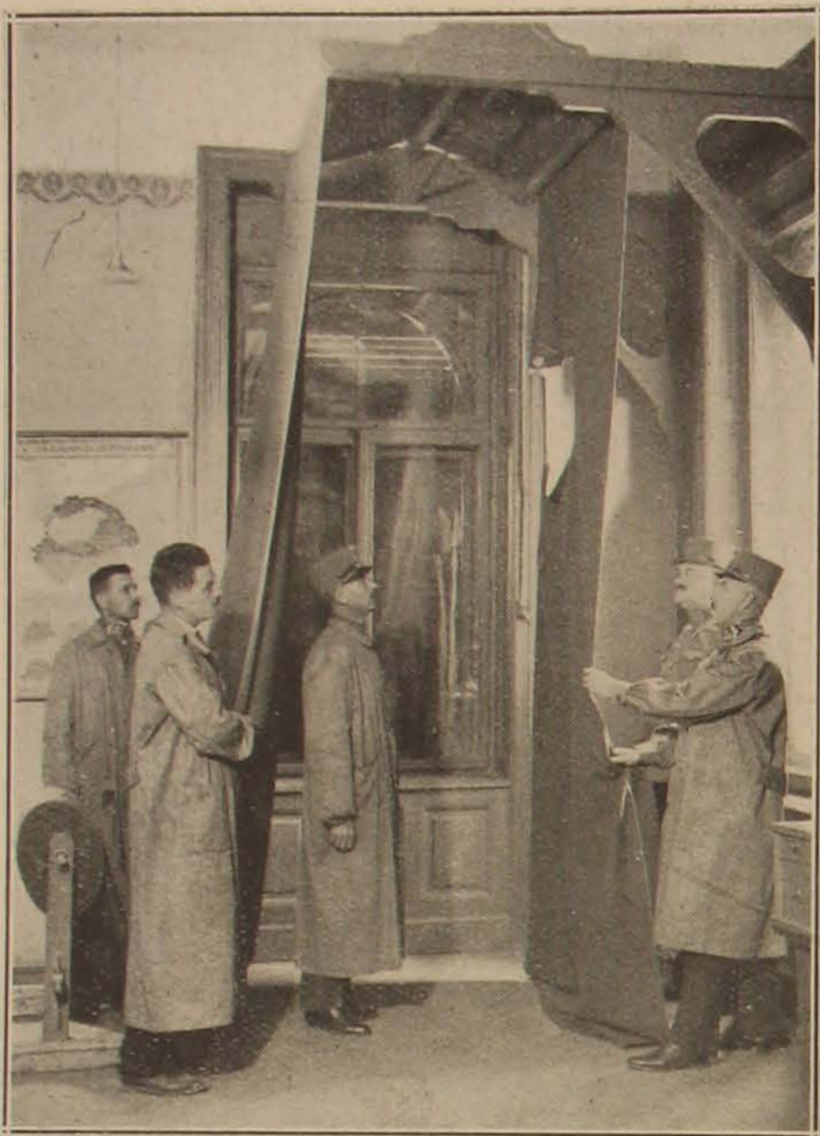
5. Szövelneműek elkészítésének mindkétoldali megvizsgálása „áthúzás” útján, egyirányú átvilágítással.
