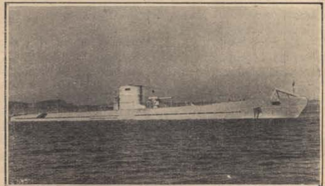
U 25 német búvárnaszád (1936-ban épült; víz felett 712 t. vízkiszorítású; víz felett 18, víz alatt 8 csomó sebességű; 1 db. 10.5 cm. ágyúja, 1 géppuskája, 6 db. 53.3 cm. torpedóvetőcsője van; 71 m. hosszú, 6.2 m. széles, legénysége: 40 fő).
