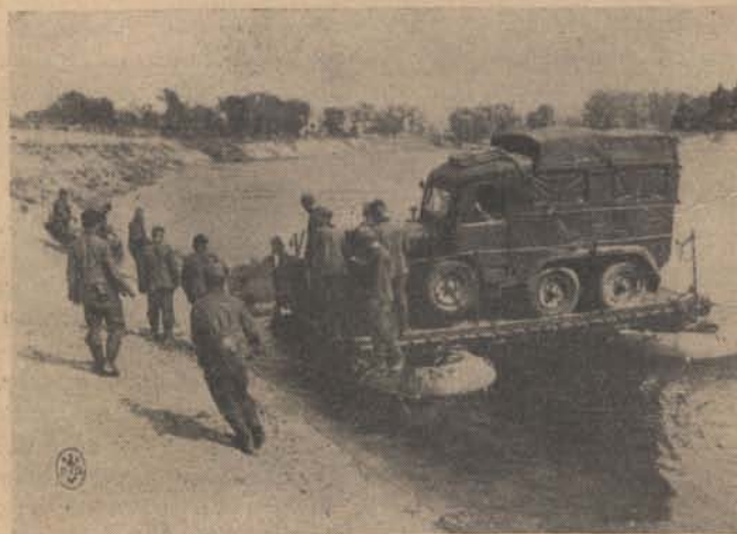
Gépkocsiszállítás a gumicsónak-tutajon.
