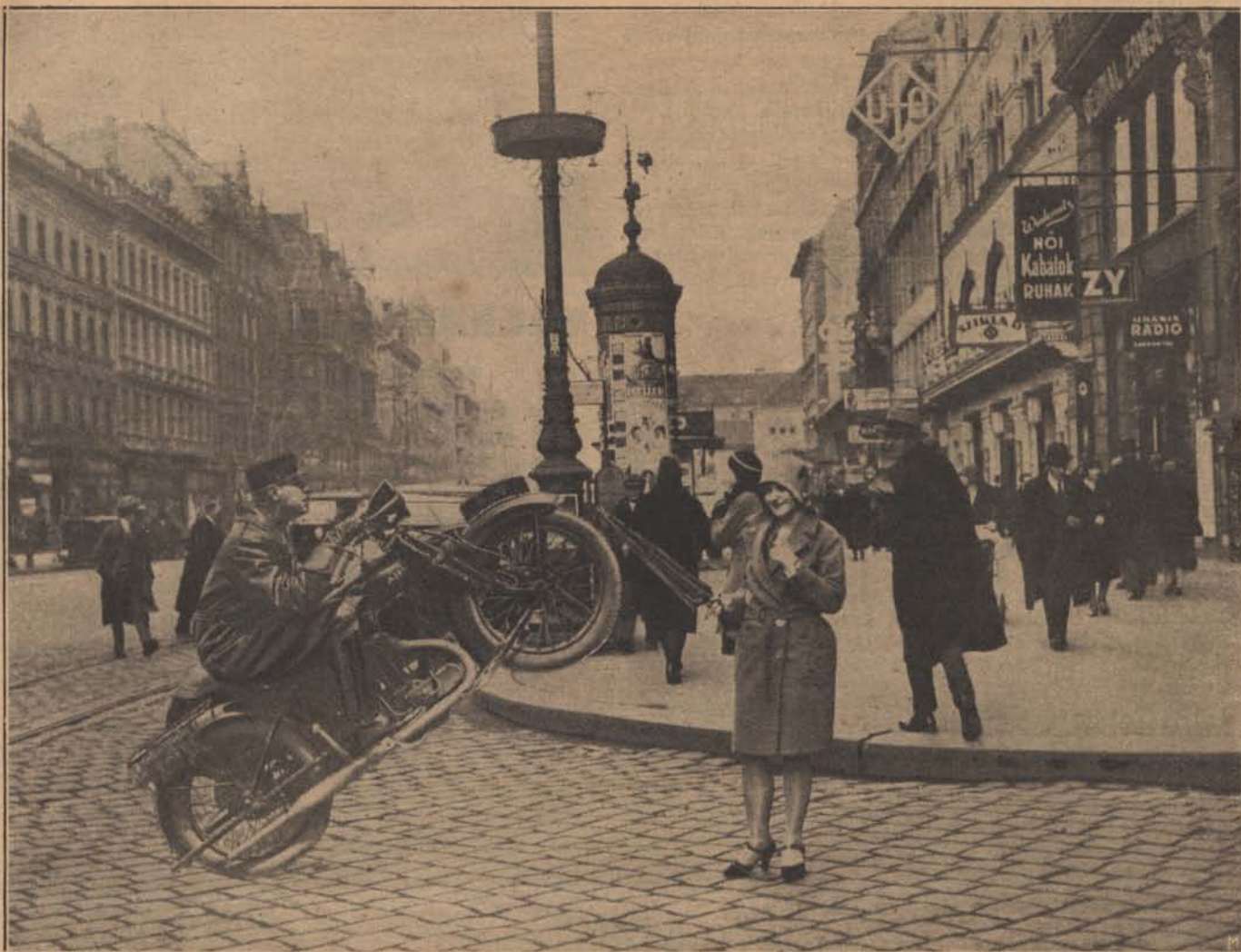
Újrendszerű féket próbáltak ki közlekedési csendőrök motorkerékpárjain. A gép a hátsó kerekére áll s ezzel az eddig elkerülhetetlennek tartott baleseteket is meg tudják akadályozni. (Schäffer felvétele.)
